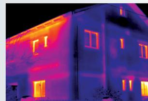
**Detecte perdas de energia em edifícios:** identifique e registre imediatamente pontes térmicas em frentes de construção ou conchas.
