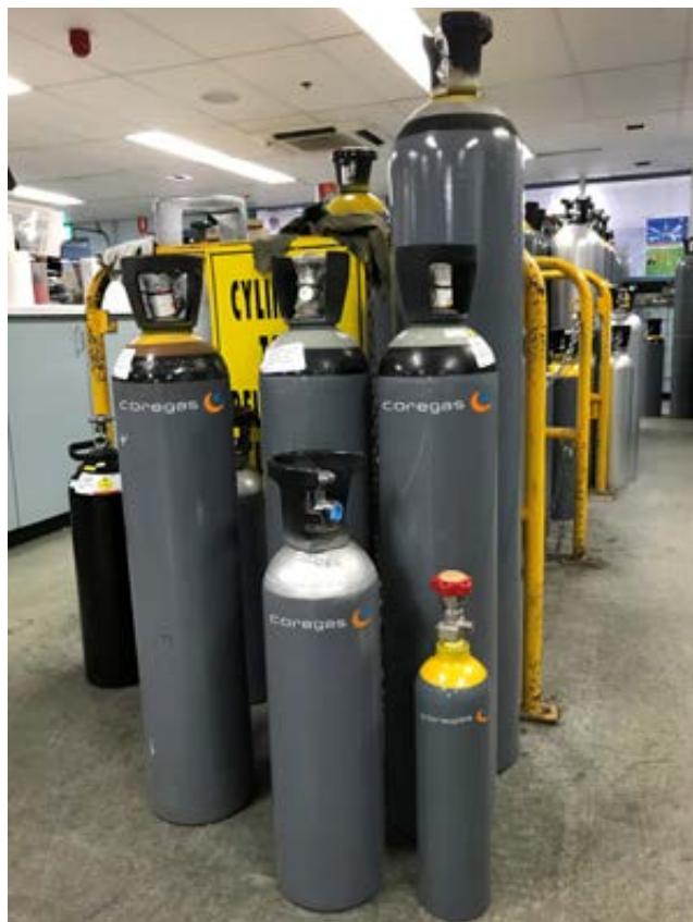
Cilindros de misturas de gases especiais para detector de gases em teste de resposta e calibração
