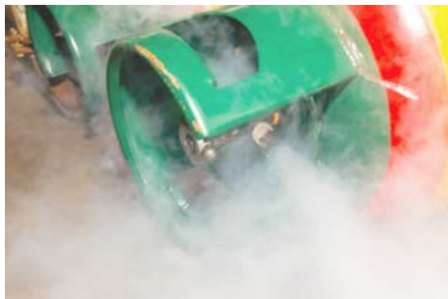
Cilindro de gás de amônia com vazamento
