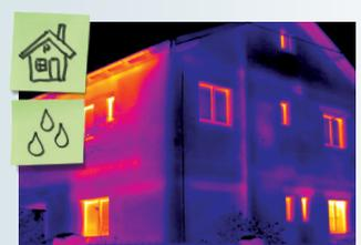
**Detecte perdas de energia de edifícios:** identifique e registre imediatamente pontes térmicas em frentes de construção ou reservatórios.
