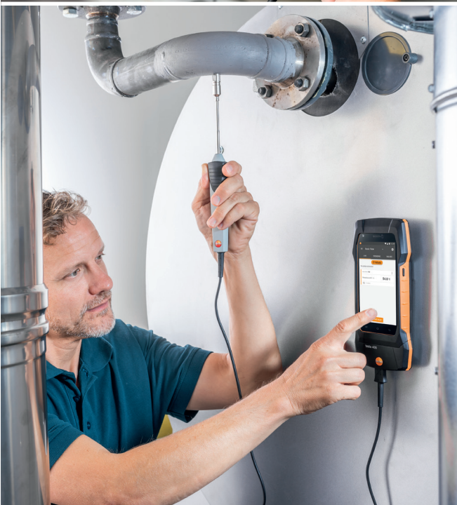
O testo 400 permite a utilização simultânea de até oito sondas (4 x Bluetooth, 4 x cabo).
